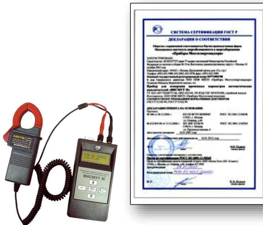
Рис.4.4. Измеритель задержки срабатывания выключателей «ВИСМУТ-М». Госреестр средств измерений № 34861-07.
