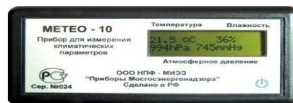
Рис.4.5. Прибор для измерений климатических параметров «Метео-10». Госреестр средств измерений № 40335-09.
