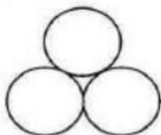
Рисунок 5 — Типовое расположение трех кабелей, уложенных в треугольник
